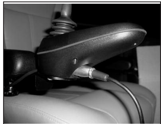
Puerto cargador independiente (situado debajo de la palanca de mando)
