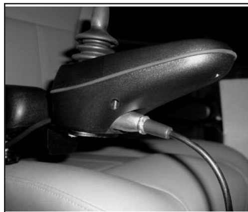
Port de chargeur non transporté (placé sous le levier de commande)
