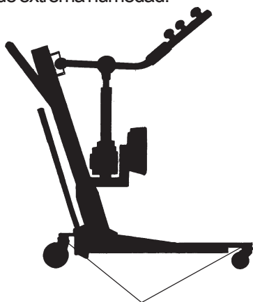
Lubrique los Cojinetes y las Ruedas Giratorias
