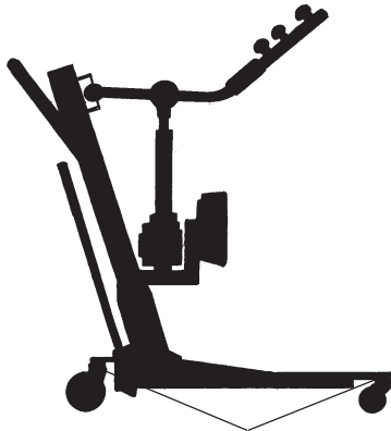
Lubrifier les roulements des pivots des roulettes pivotantes
